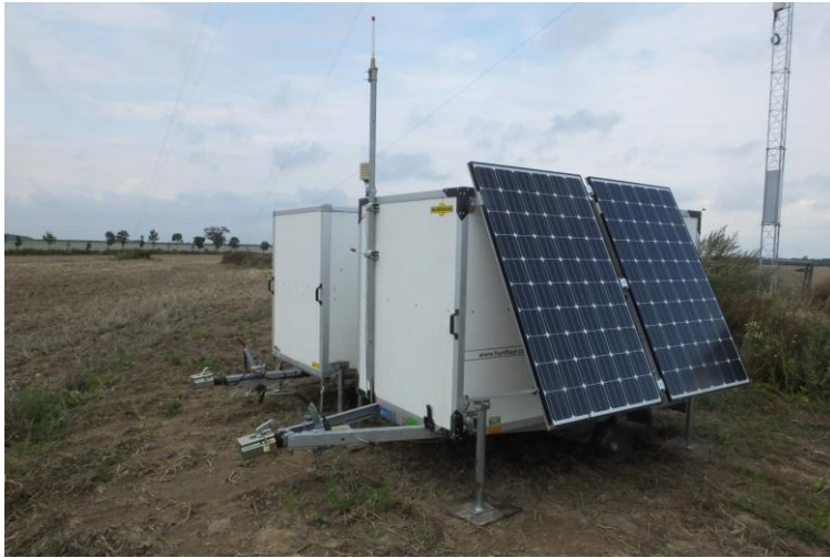
Fig. 5: Verificação de dois dispositivos LiDARs (dentro dos trailers) contra um mastro de medição – Campo de Verificação da BBB na Alemanha
